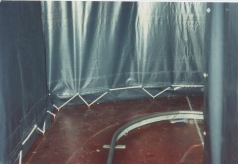
Oben: Einfahrtskorridor mit Planen links, die parallele Fahrstrecken abschirmen. Unten: Kurve mit Planen zur Abschirmung paralleler Fahrstrecken. Geisterbahn, ehem. B. Hersche (1991).
