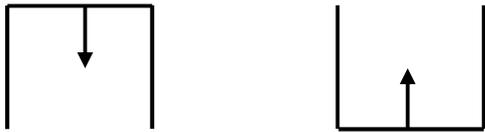
Hier gibt es nur 1-teilige horizontale Öffnungen. Von oben nach unten treten sie v.a. bei englischen Fenstern auf, von unten nach oben bei einigen appenzeller Riegelbauten, worauf der Architekt Salomon Schlatter hingewiesen hatte.
